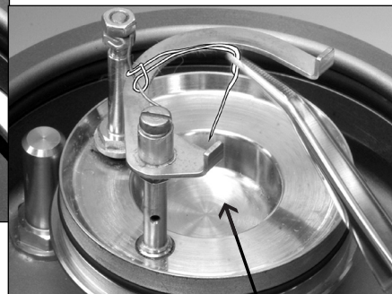
Zagłębienie na wsad w postaci destylowanej wody lub roztworu
